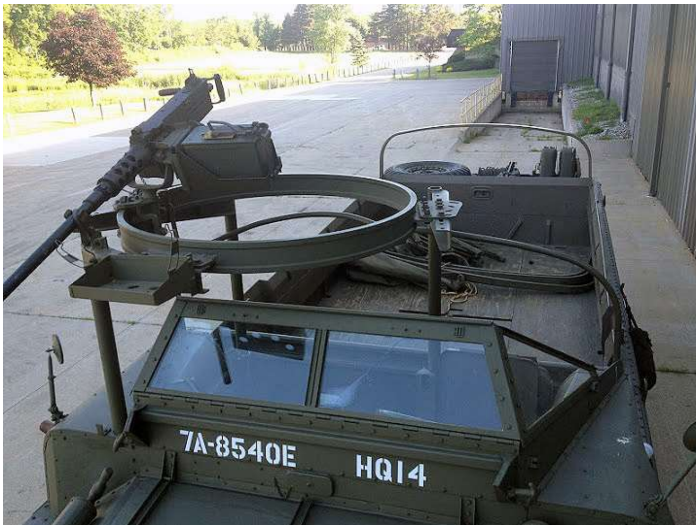
Detail lafety pro kulomet M2HB na vozidle GMC DUKW 353
