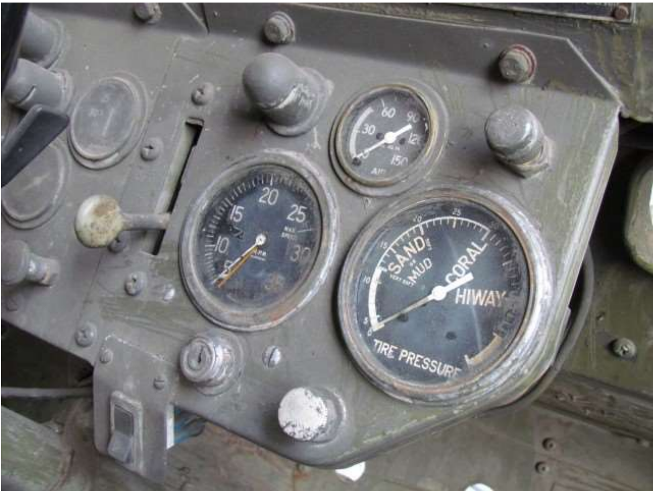
Detail palubní desky s ukazatelem tlaku v pneumatikách
