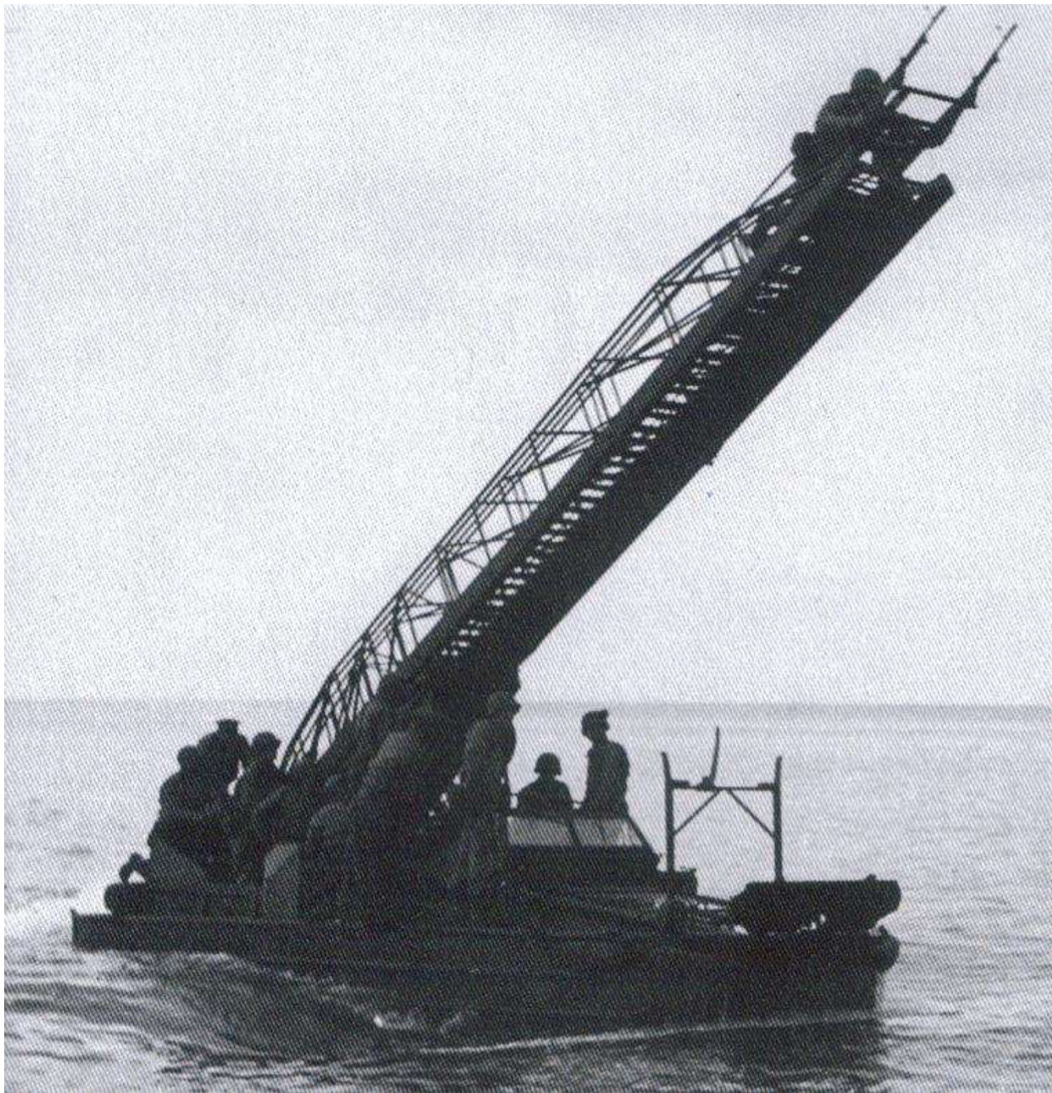
Jeden ze čtyř exemplářů DUKW 353 vybavených 25 m dlouhým hasičským žebříkem. Na konci byla namontována dvojice kulometů ráže 7,7 mm k palebné podpoře výsadku
