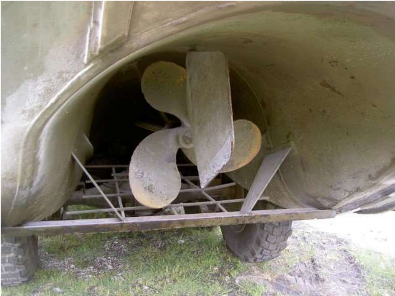
Detail hnací části pro pohyb ve vodě
