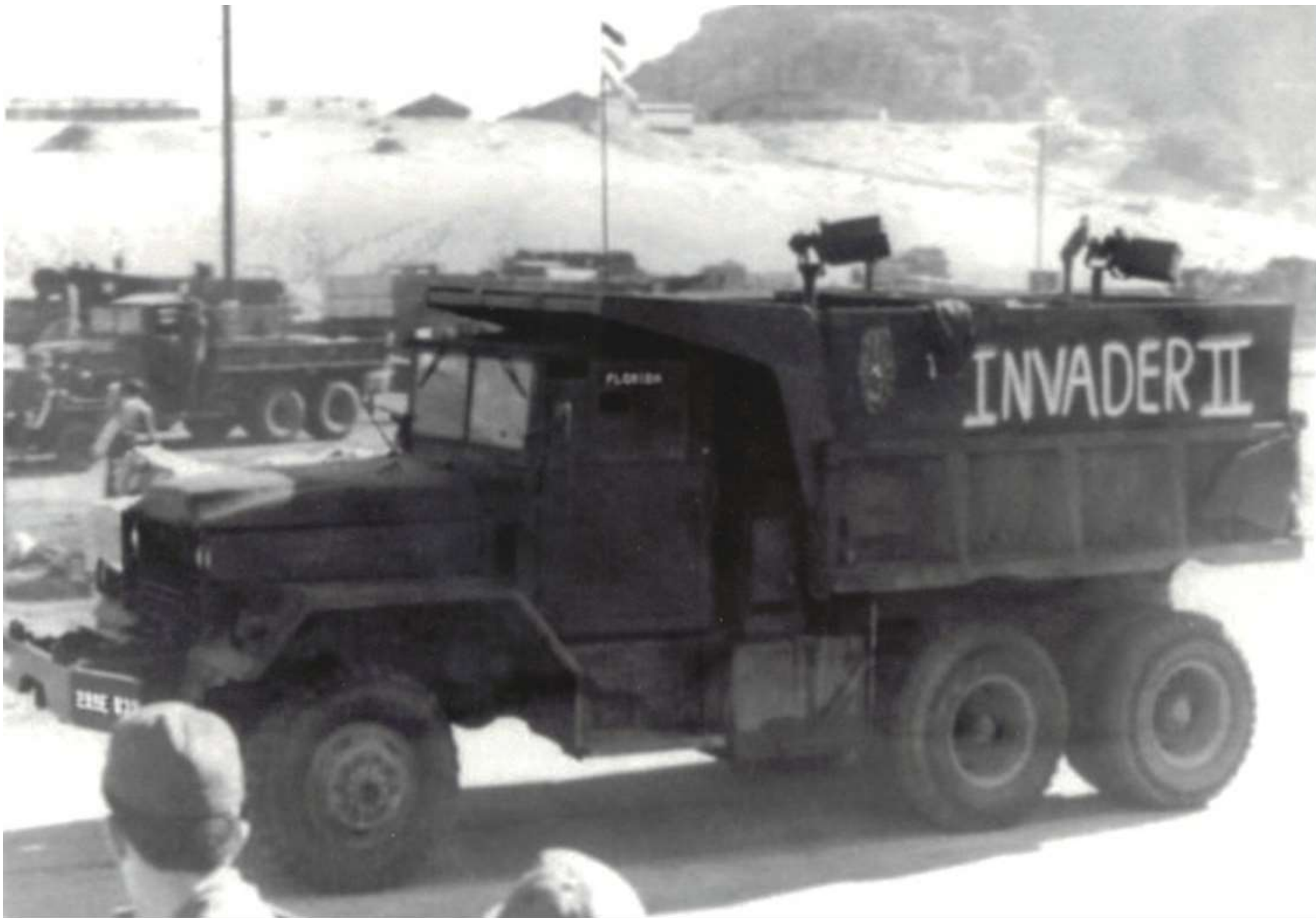
K přestavbě na gun truck byly využívány i sklápěče
