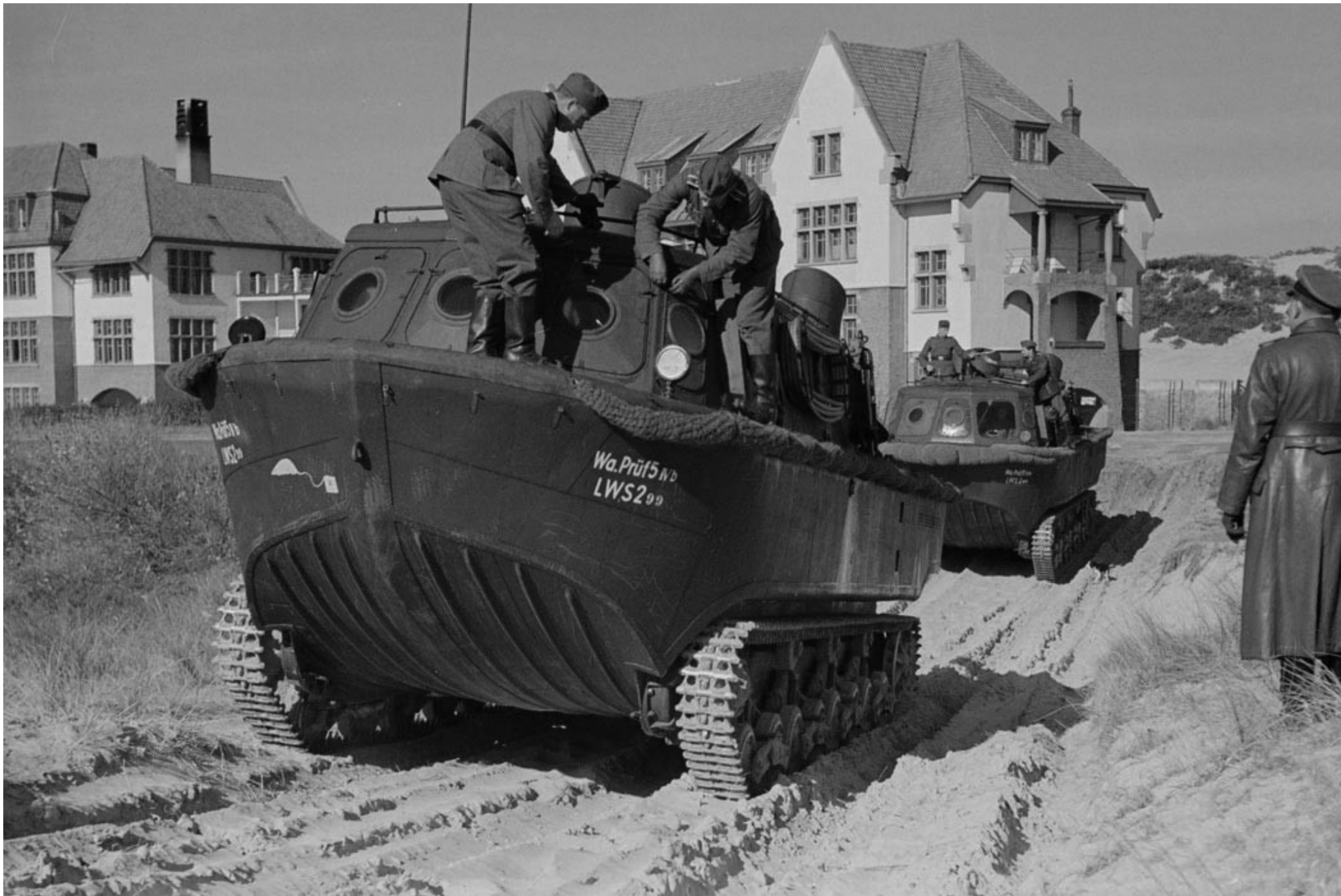
Druhý prototyp LWS I pod označením LWS 2 vyfotografovaný během zkoušek na pláži u belgického města De Haan v září 1940
