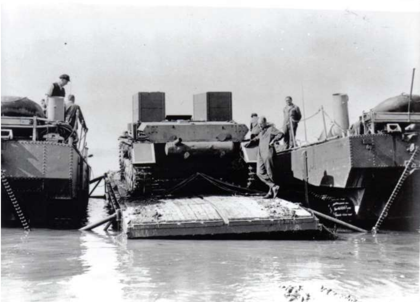
Vylod'ovací sestava Panzerfähre sestavená ze dvou LWS II a pontonem s naloženým podvozkem PzKpfw IV
