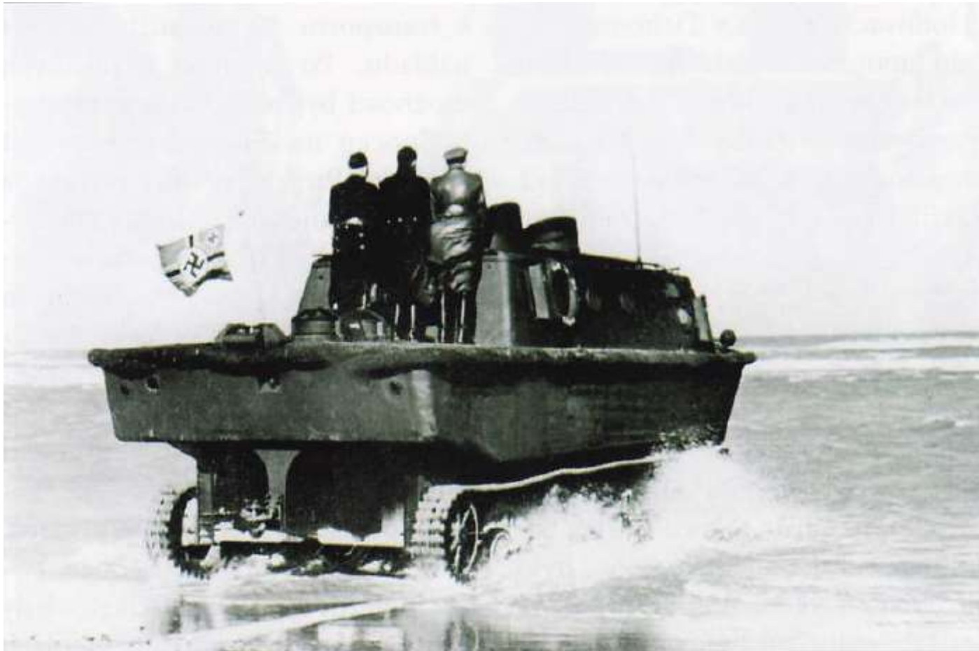
Třetí prototyp obojživelného tahače, který dostal označení LWS 3, vjíždí do vody. Jelikož toto vozidlo sloužilo u válečného námořnictva vlaje nad ním vlajka Kriegsmarine
