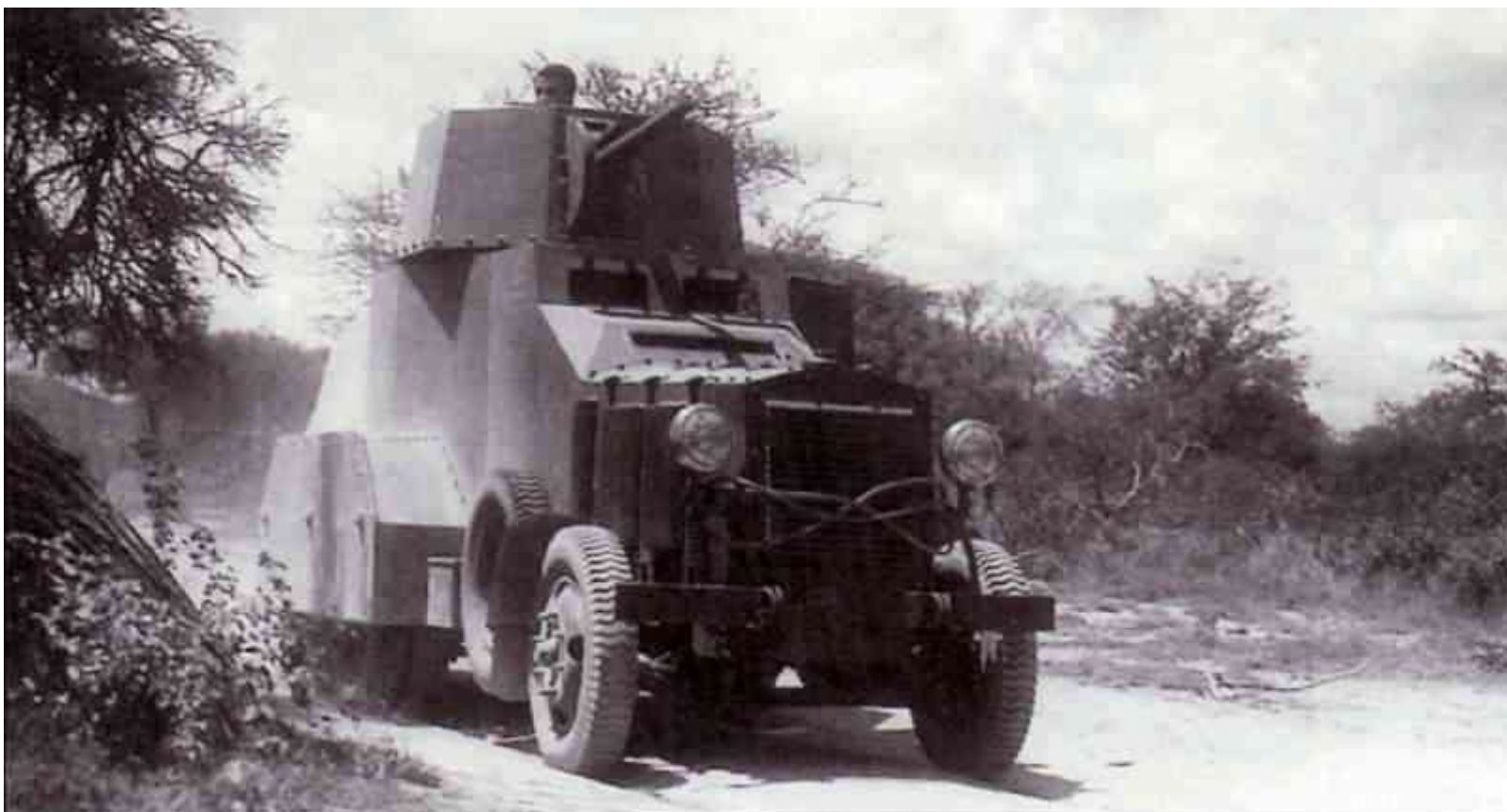
Obrněný automobil AB 34 (Fiat 611) ve verzi B vyzbrojený 37 mm kanonem Vickers Terni 37/40 mod.30
