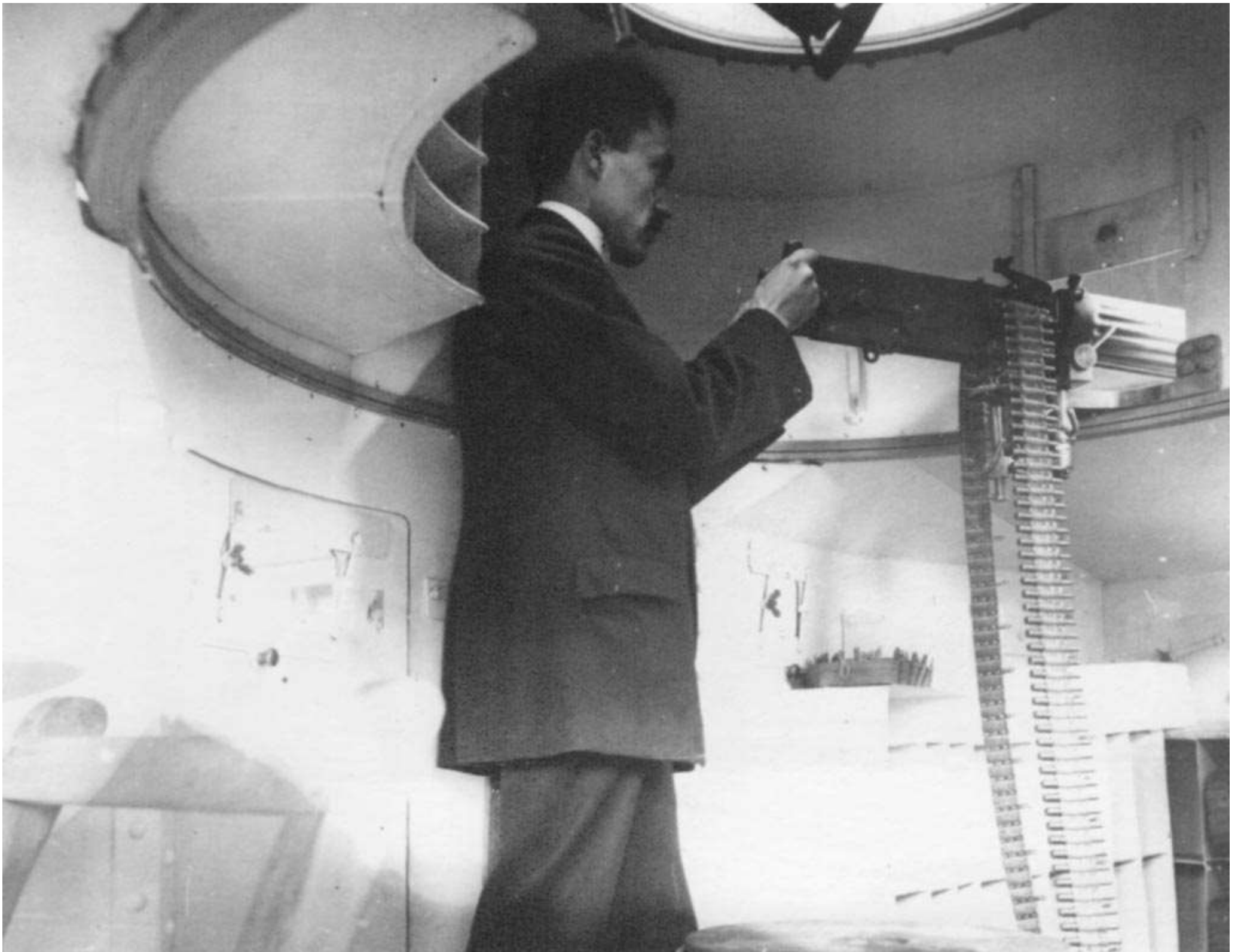
Vnitřek věžového systému obrněného automobilu Lancia IZ
