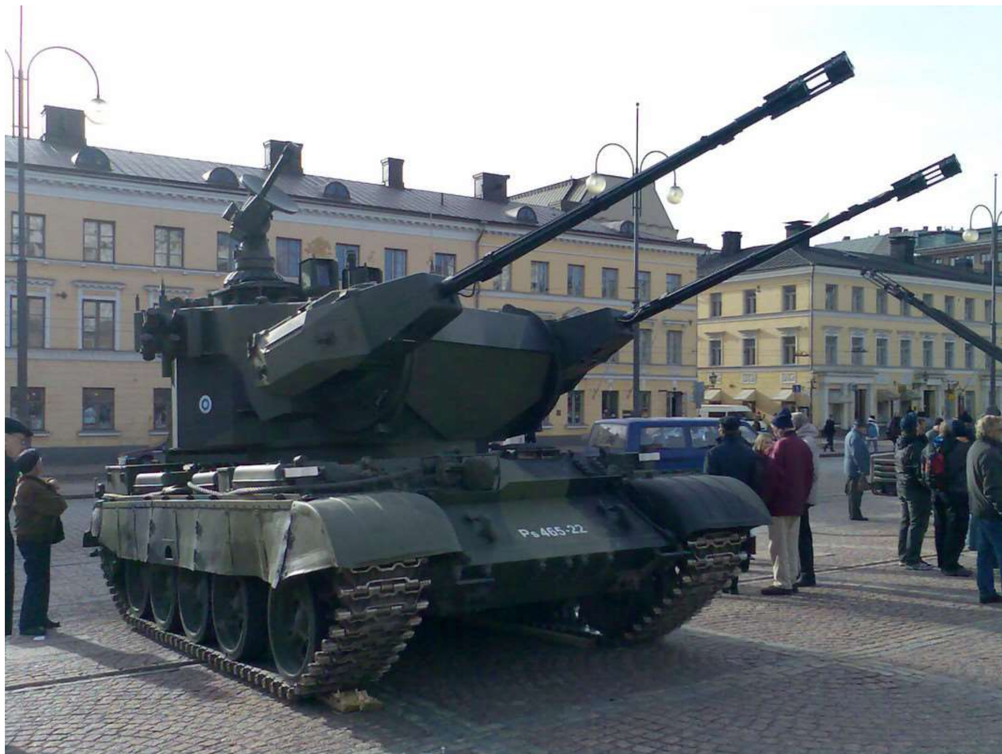
Samohybné protiletadlové dělo na podvozku Type 59 s věží Marksman
