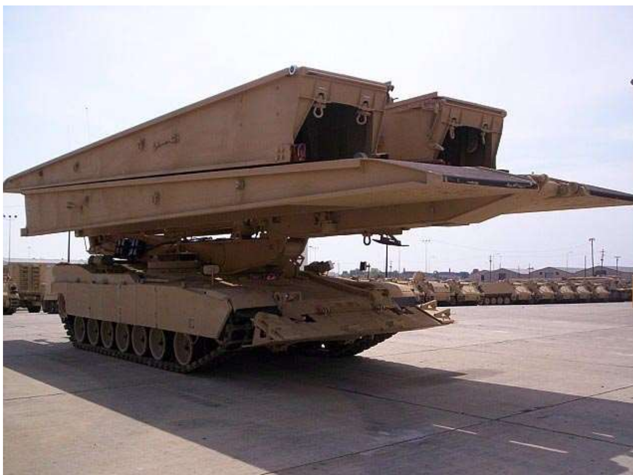
M104 Wolverine je mostní tank s těžkým mostem HAB (Heavy Assault Bridge).
