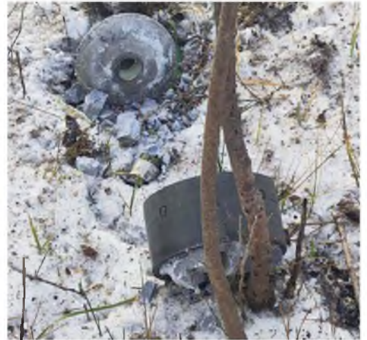
Разрушенная от падения мина М70 (М73). Видны обломки высыпавшегося ВВ
