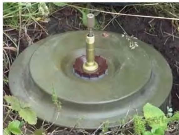
Снаряженную втулку вкрутить в мину
