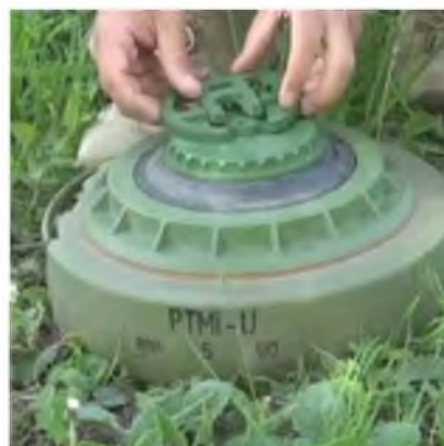
Извлечение вставки-ключа.
