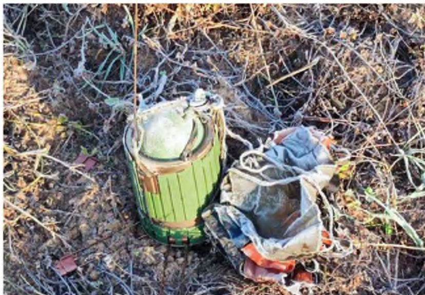
Мина DM1399 встала правильно. Виден парашют, антенна-датчик цели торчит.
