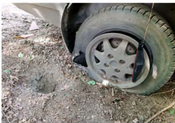
Повреждение колеса автомобиля на дороге в зоне СВО, предположительно миной М70 (М73)
