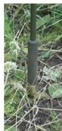
Избегая наклона, установить штыревой датчик
