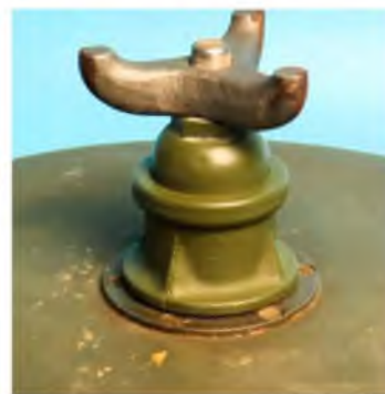
Датчик цели m/49, вкрученный в гнездо мины
