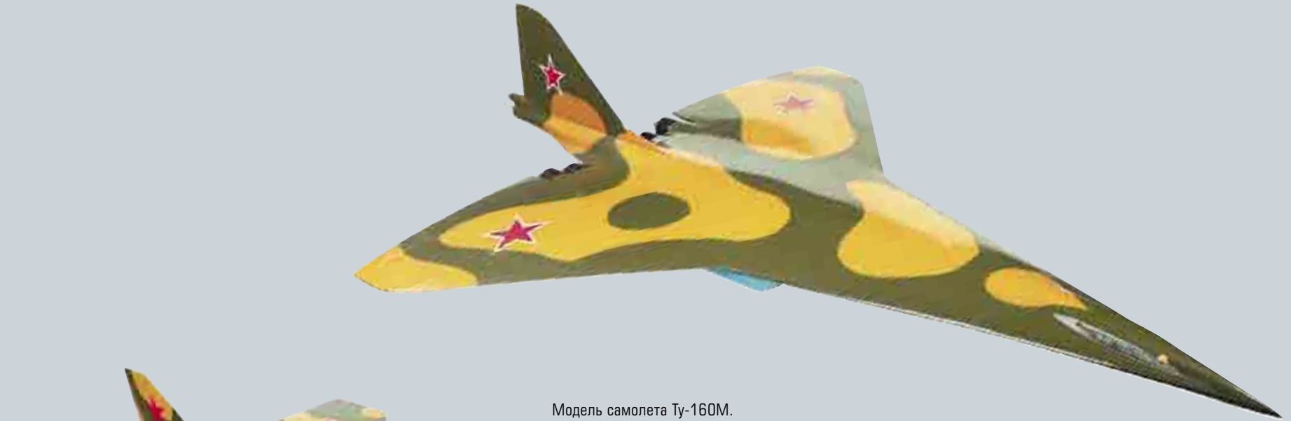
Модель самолета Ту-160М. Вариант, рассматриваемый в аванпроекте 1970 г.
