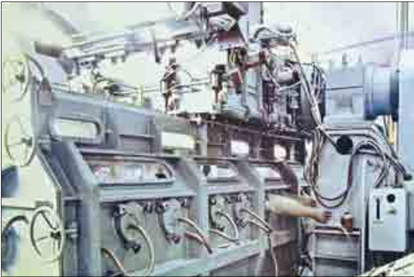
Камера рукавная для дуговой сварки в контролируемой нейтральной атмосфере на Московском филиале нашего предприятия
