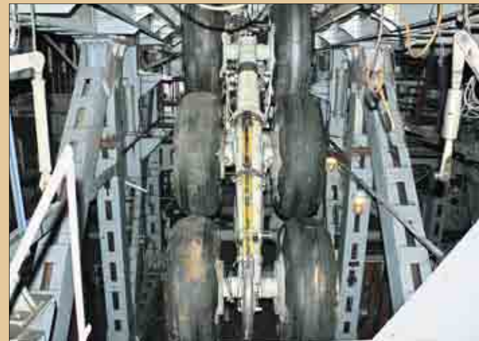
Стенды ресурсных испытаний систем уборки-выпуска шасси
