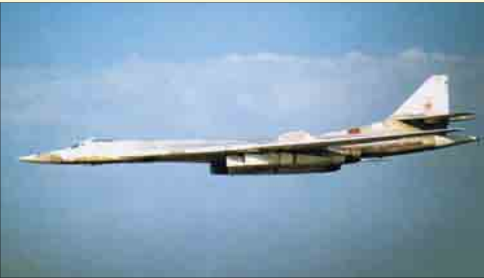
Скоростной пролет самолета «03» со сложенным крылом (стреловидность 65°)
