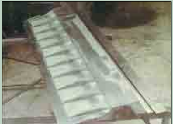
«Переходник». Деталь центральной балки, выполненная из титанового сплава
