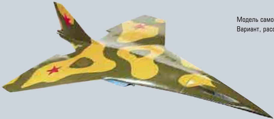
Дальнейшее развитие Ту-160М. Модель самолета в варианте с отклоняемыми носками крыла
