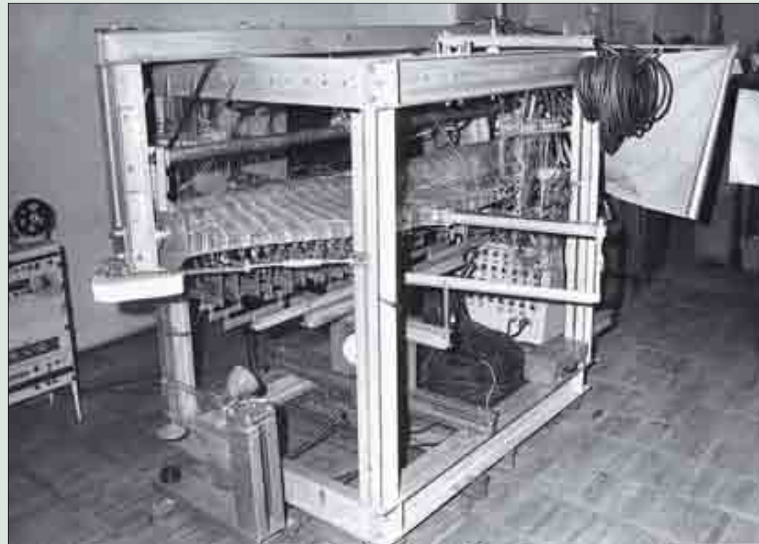
Испытания модели из оргстекла с измерением напряжений
