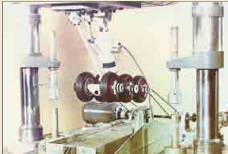
Испытания на модели шасси Ту-160 по определению ударных нагрузок
