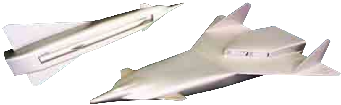
Модель стратегического самолета-ракетоносца Ту-139. Проект предусматривал создание авиационно-ракетной системы, вооруженной баллистическими ракетами воздушного базирования, 1964–1965 гг.
