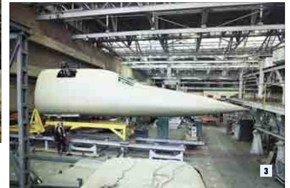
1, 2. Сборка интегрального агрегата: фюзеляж – передняя часть крыла. ММЗ «Опыт», 1979 г. 3. Стенд для отработки аварийного покидания самолета.
