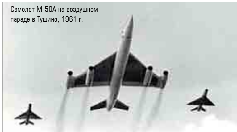
В процессе испытаний самолет М-50А оснастили двумя ТРДФ ВД-7М (на пилонах под крылом) и двумя ТРД ВД-7Б (на концах крыла)
