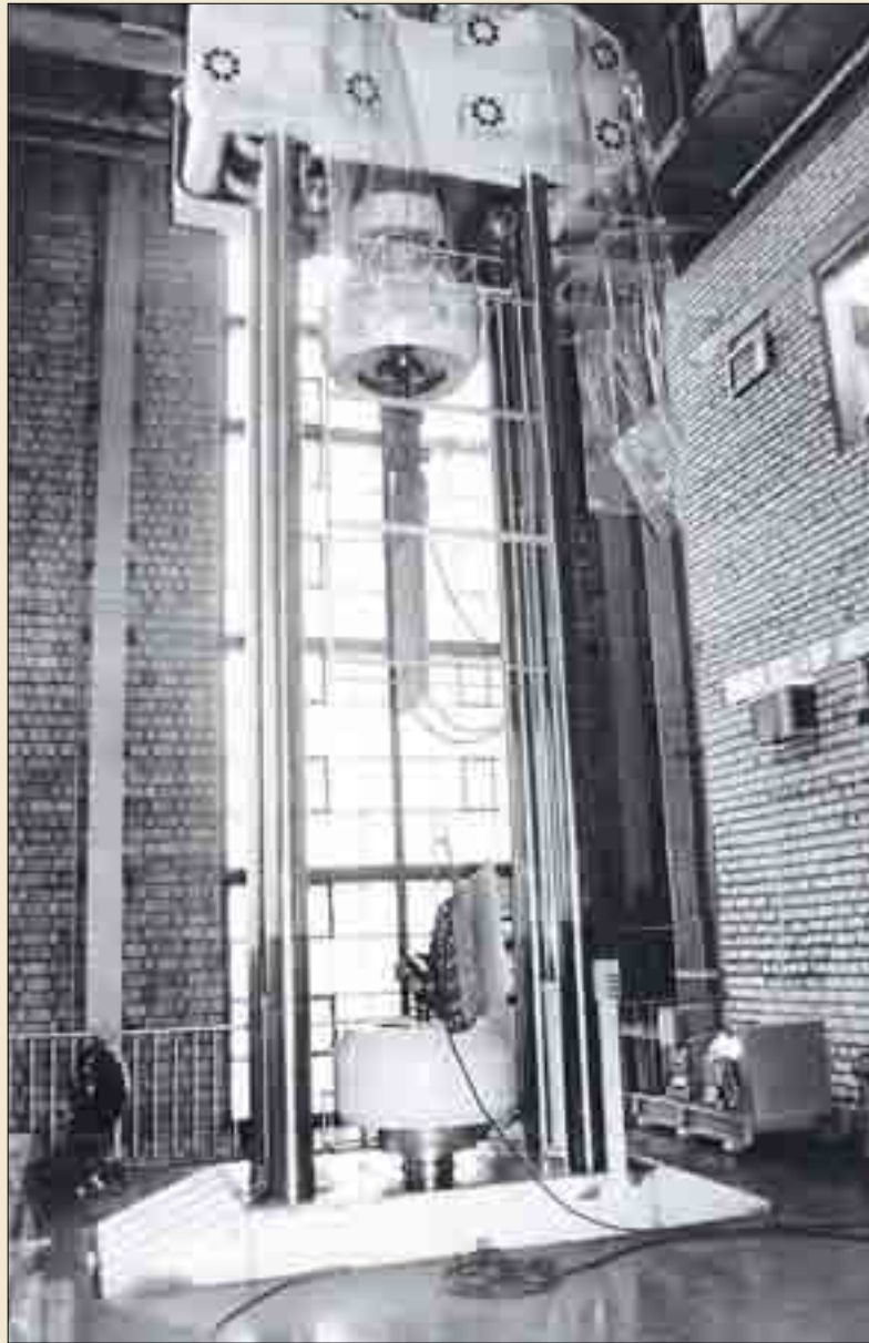
Опытная панель крыла, подвергнутая испытаниям до разрушения. Для статических и усталостных испытаний по отработке конструкций узлов и агрегатов самолета Ту-160 применялись самые современные испытательные средства
