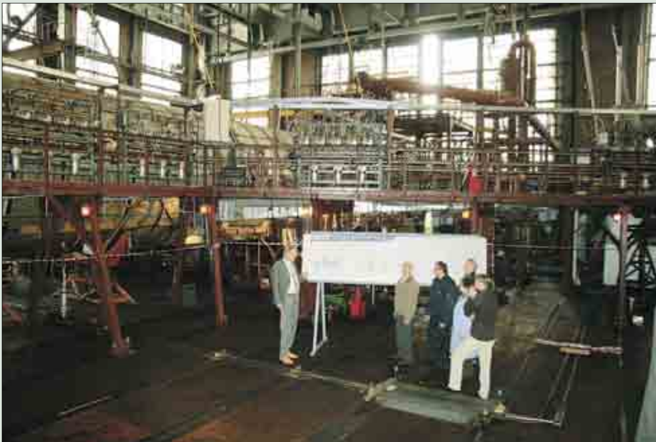
В. П. Шунаев (слева) объясняет работу стенда ресурсных испытаний самолета Ту-334, ЛИК ОКБ
