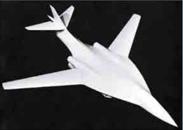
Тактическая модель варианта «вертикаль» («двухстволка»)
