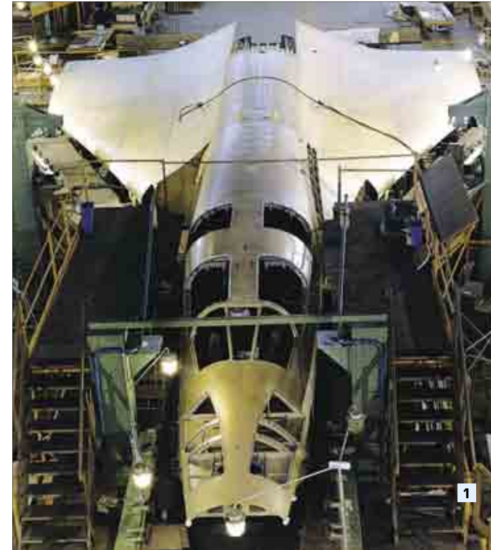
1, 2. Сборка интегрального агрегата: фюзеляж – передняя часть крыла. ММЗ «Опыт», 1979 г. 3. Стенд для отработки аварийного покидания самолета.
