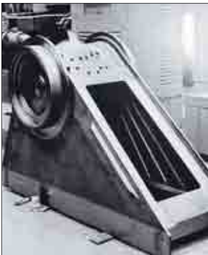
Узел поворота (агрегат № 19, неподвижная часть) из секций, соединенных с применением электронно-лучевой сварки
